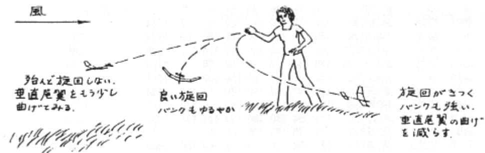
垂直尾翼をわずかに曲げたつもりでも、旋回のバンク（傾き）がきついことがあります。その場合はテストを止めて両側のアライメントをしらべましょう。つまり左右の主翼が振れたりしていないかをしらべます。（\*：これは非常にわずかでも利くので注意深くしらべて下さい。特にランチングの高速時に影響が強く出て極端なときは左右いずれかに突込むことがあります）
