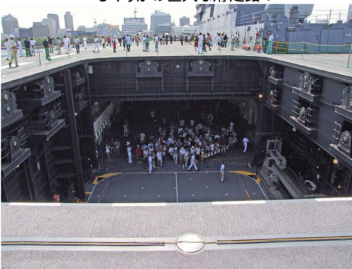
巨大な昇降機と格納庫
