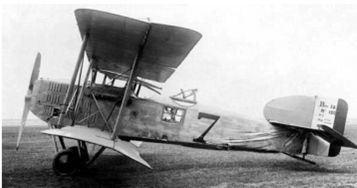
注:ブレゲー14は爆撃機で主翼がかなり大きく、エンジンは当時としては強力な300馬力で重量物運搬に向いており、金属骨組みで頑丈だった。戦後はブレゲー14を改良して輸送機型Br14T bisとしたようです。ブレゲー14Tはエンジンを350馬力としプロペラも4枚羽根になり、速度190km/hに増加し上昇高度は約4,500m。1919年夏からパリ・ロンドン間を客と郵便袋をのせて定期運航した。
