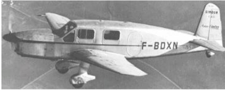
注:コードロン・シムーンは1930年代にフランスで作られたスポーツ・旅客用(4人乗り)の小型機です。総製作機数200機以上という、当時としてはベストセラー機だった。エンジン出力はわずか220馬力で時速300km/hを出します。この機体は、数々の記録飛行に使われたことでも有名。
