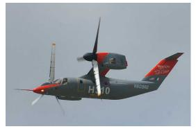
は商業用ティルトローター機が実用化を目指して開発中です。民間機としては、イタリア・フィンメカニカ社のAW609 が 20 03 (平成 15)年に初飛行しています。同機は 510km/hの速度と 2036kmの航続距離を持ち、最大9名が搭乗可能です。世界的に需要の多い海底油田への人員輸送や、VIP輸送といった用途を見込み、計画が遅延してはいるものの、2017年には量産機の引き渡しがされると目されています。ティルトローター機は「高価」という欠点を持ちますが、大きすぎる「オスプレイ」よりもずっと小さいAW609 ならば、「オスプレイ」の 3 分
