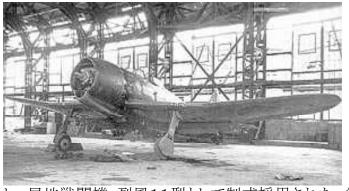
手一杯であったため、1941年に一旦中止となった。それから1年後の1942年海軍は十七試艦上戦闘機と改めた後継戦闘機の開発を三菱に内示した。そして一息ついた堀越以下の設計陣が開発に当たることとなった。海軍が提示した十七試戦闘機計画要求書の要求性能は、最高速度 638.9km/h以上、上昇力 6,000mまで6分以内、航続力 463.0km/h巡航で5時間、武装 20mm機銃 2 挺 13mm機銃 2 挺であった。1945年6月に試作機が完成
