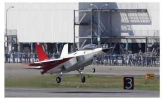
れる主な技術的要素は、「飛行推力統合」「ステルス」「機体構造」「システム統合」の4つです。「飛行推力統合」とは、戦闘機として必要な高い機動性を実現するもの。X-2 は機首の上げ下げを行う水平尾翼、左右の傾きを変化させるエルロン(補助翼)、左右の横滑りを修正するラダーといった通常の飛行機で用いられる各種動翼に加え、2基搭載された国産のIHI XF-5-1 エンジンの排気の向きを直接傾けて姿勢を変化させる「推力偏向パドル」を有しています。 水平尾翼は飛行速度がなやいと姿勢を変化させられないので、速度が遅
