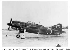
機体後部が大幅に変更されており、そのまま使用できたのは操縦席付近のみであった。しかし主翼については、中翼で車輪収容部分を加えた他はほぼ原型のままで、翼型も航空研究所で開発されたLB翼型(層流翼)が強風より引き継がれている。自動空戦フラップも装備していたが、初期段階ではトラブルに見舞われた。
