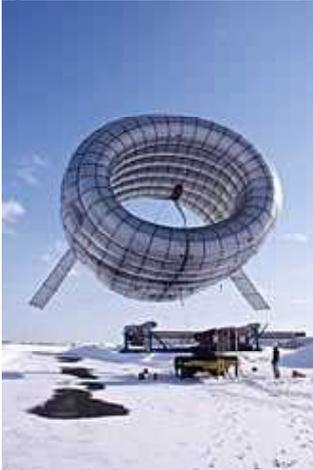
三菱重工業とオマーンのスヘイル・バーワン・グループ(SBG)は、アルタエロスが進める空中浮体式風力発電設備(BAT、写真)の開発と商用化を支援する。BATは、ヘリウムガスを充填させた直径約10mの風洞型気球で、中心に風車がある構造。地上約600mの高さに浮上し、上空の強風を受けて風車が回り発電する。同規模の従来型風力発電設備に比べ2倍超の電力量を発電できる。また、設備はトレーラーによる運搬が可能。基礎工事は不要なので、目的地に運搬後、素早い設置ができる。このため、送電網のない地域や島嶼、僻地、さらには災害地域などでの電力供給に適している。アルタエロスは2010年に米国のマサチューセッツ工科大学で設立されたベンチャー企業。同社が取り組む新しい風力発電技術の開発プロジェクトには、米国農務省や米国立科学財団をはじめとする数多くの政府機関や有力企業が支援を表明している。
