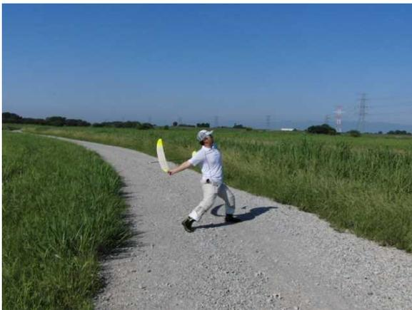
強風用のスパン70cmの小さ目Aサイズの上昇パターンはいつもと変えています。尾翼は珍しくY形式です。上反角が強くアップも強めで左Vにだけアップを入れて右Vは触りません。ラダーは2mmほど右に切ります。主翼の右翼の2段目接合部付近の後縁を3mmほど下に曲げて固めています。こうしたセッティングにすると縦の大きなバレルロールのような感じで上昇して頂点で機首が風上を向いて滑空に入ります。コークスクリューとまではいかない感じのスクリューパターンです。なぜこの形にしたのかですがスパイラル防止が目的です。アップ強めで右翼を受けているのでスパイラルに入り難いセッティン
