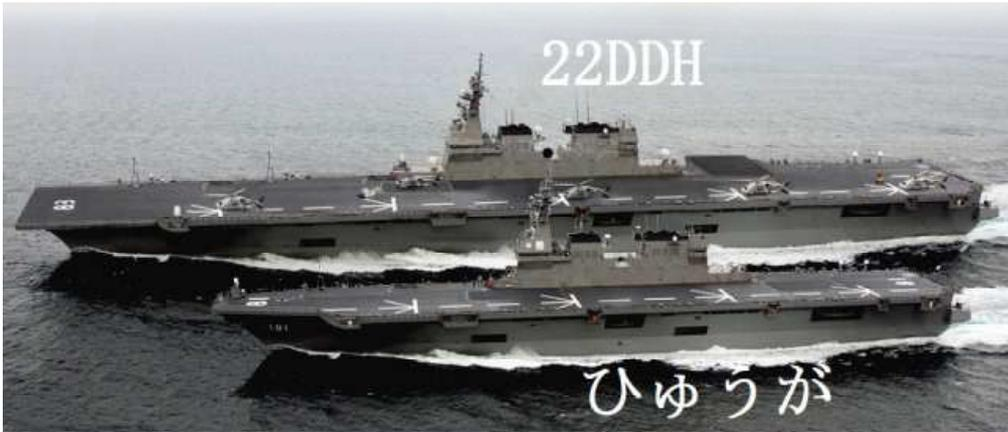
「いずも」はトン数が小さいにも関わらず、船体が大いなのは日本の造船技術の進歩である。剛性を確保しながら大型化する技術は、材料を節約して船体を軽くする日本の商船技術の転用である。
