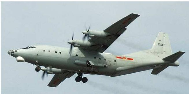
Y-8とは、中華人民共和国で製造されたターボプロップ4発中型輸送機の改良型である。Y-8は、1960年代にソ連・ウクライナのアントノフ設計局の製作したAn-12輸送機(1957年初飛行)をデッド・コピーしたも。当初はAn-12をライセンス生産する計画であったが、中ソ対立のためにソ連からの技術援助が打ち切れ、中国の技術陣が輸入したAn-12を参考に開発を続行した。そのため
