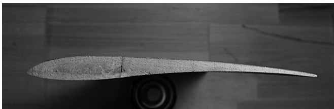
右上、薄翼、前縁削上50%程度その割りにフラップは大きい。
