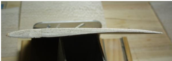
右上、薄翼、前縁削上50%程度その割りにフラップは大きい。
