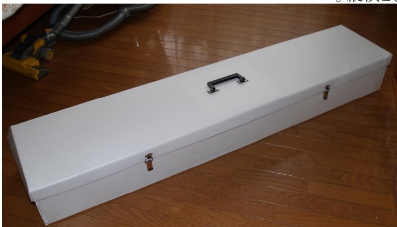
3. 取手、パッチン金物を付けて完成
