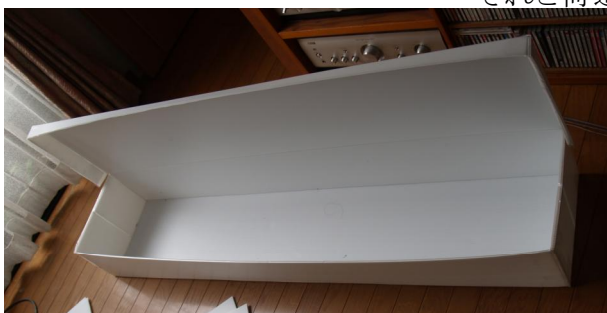
2. 板を荷造りテープで組む
