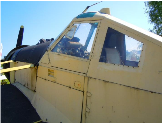
[写真 10] コックピットの下部の折れ線部が分かる。
