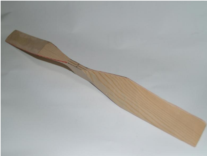
左右下面の削りが完了し上面の荒削り
