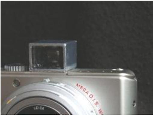
そして写った映像をモニターで確認しながら、ファインダーの左右位置を補正する。何回かテストをして、これがOKとなったら、次に上下関係をチェックする。私のカメラの場合は、ファインダー後部にケント紙を1枚をかませピタリの位置となった。位置が決まったらテスト写真を撮る。そして狙ったところにピントが来ているかと、映像がねらい通りかどうかを確認する。ファインダーのピント位置とカメラのピント位置がそろわないと焦点が合わずにピンぼけとなる。デジタルカメラの有難いところは、テストの為に何回写真を撮っても、即画像が確認できて即消去できる事である。ほぼOKなら実際に写真を撮って、パソコンに取り込んで大きな画面で確認してみよう。
